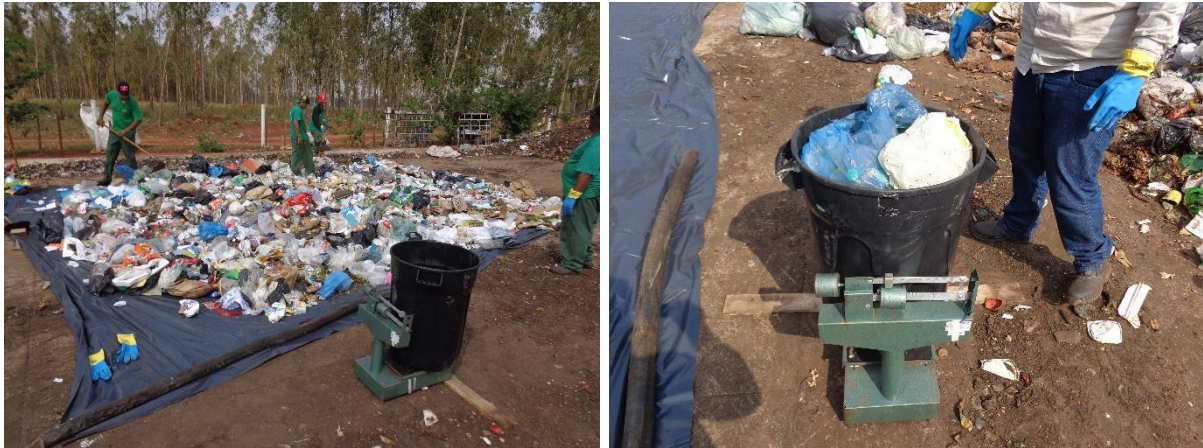
Figura 79 – Realização do ensaio de determinação da massa específica aparente dos resíduos domiciliares e de prestadores de serviços de Naviraí/MS.
