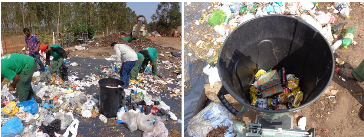
Figura 83 - Execução da segregação das tipologias dos resíduos após o segundo quarteamento e pesagem dos materiais triados.
