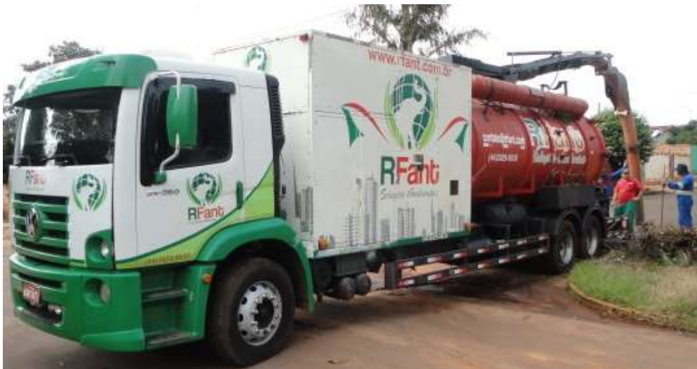
FIGURA 61: LIMPEZA DA BOCA DE LOBO.
