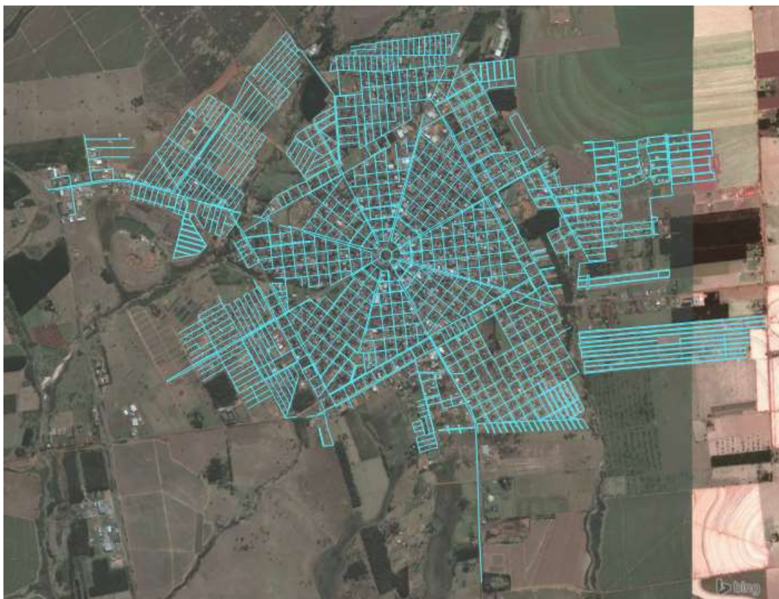
FIGURA 1: COBERTURA DA REDE DE ABASTECIMENTO DE ÁGUA DE NAVIRAÍ.
