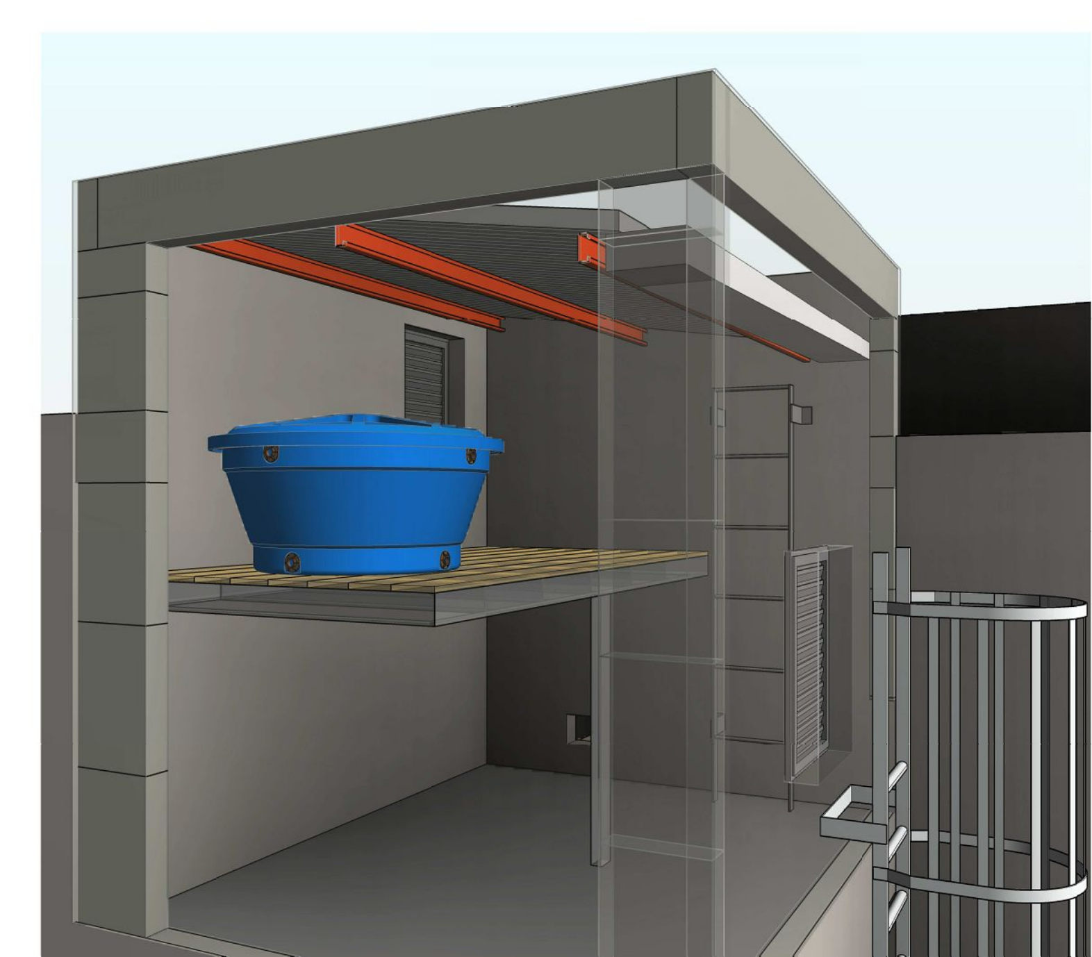
5 DETALHE CAIXA D'ÁGUA RECEPÇÃO
