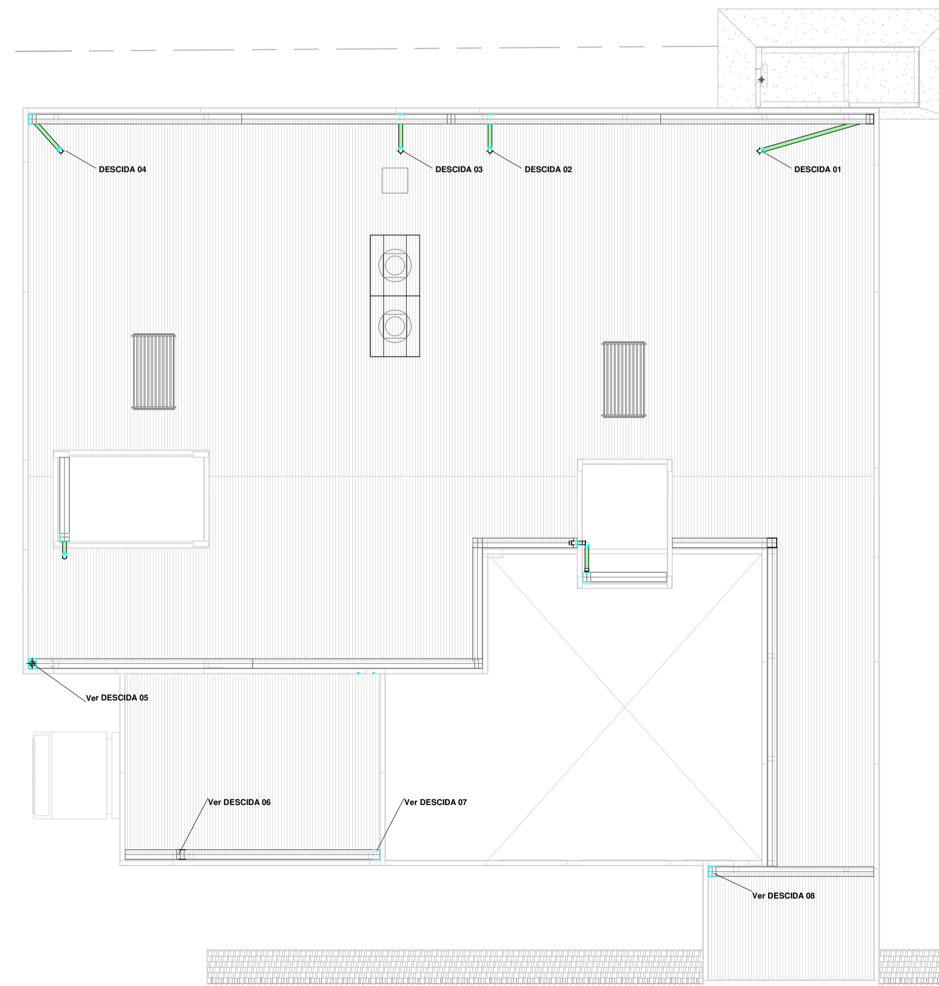
2 COBERTURA PLUVIAL DESCIDAS 1 : 100
