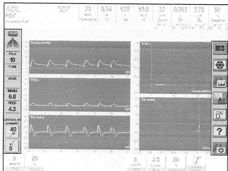
Fig. 4-4 Destaca-se a barra direita onde se situam os comandos sensíveis ao toque de algumas funções, e a barra esquerda onde, entre outras coisas, indica o monitoramento numérico das pressões.
