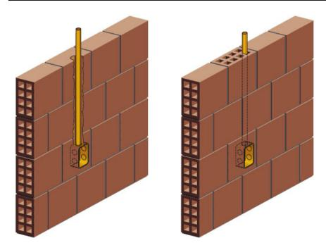
Os eletrodutos deverão estar secos, limpos e livres de rebarbas e/ou qualquer elemento que possa vir a danificar o isolamento dos condutores, antes da enfiação. Todos os eletrodutos projetados para a passagem de cabos de lógica deverão ser de aço galvanizado e manter uma distância mínima de 20cm, ao longo de seu percurso total, de todo e qualquer eletroduto que contenha fiação de energia elétrica e/ou telefonia.
