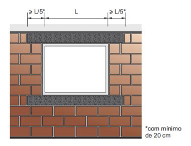
Em todas as portas e vãos deverão ser instaladas vergas, de modo a evitar fissuras, conforme detalhamento de janela visto anteriormente.
