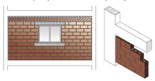
Em todas as janelas deverão ser instaladas vergas e contravergas, de modo a evitar fissuras, conforme detalhamento abaixo.
