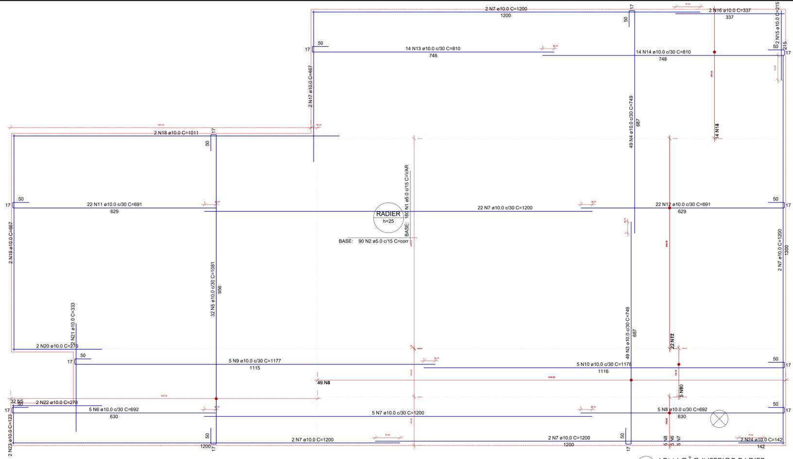
**DETALHE DA ARMADURA DE MALHA BASE**
